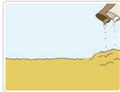
2 Inserción de capa de material inerte
